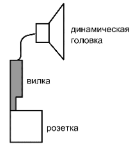
Рис. 2. Подключение головки к плате подклочений
