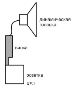
Рис. 2. Подключение головки к плате подклочений
